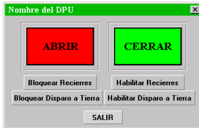
Figura 4 Ventana de Operación de apertura o cierre de un interruptor
