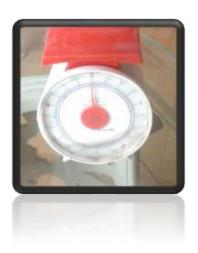
Para este experimento se utilizaron las rejillas para su respecto pesado incluyendo las partículas de polvo, luego de esto, se procede que el pesado de las rejillas sin dichas partículas de peso, donde se pudo evidenciar que el peso de las rejillas incluyendo las partículas eran de 90 gr y el peso de estas sin las partículas de 75 gr.
