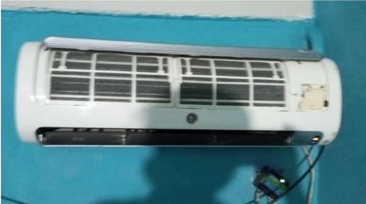
Luego de 76 horas se retiraron los filtros y se procedió a pesar nuevamente, obteniendo para ambos filtros una masa total de 61 gr.
