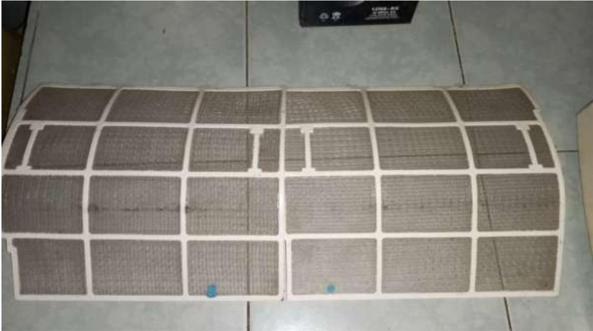
La cantidad de partículas que recogió el filtro se expresa la diferencia entre la masa del filtro completamente limpio y la masa del filtro luego de haber sido utilizado durante 72 horas continuas.
