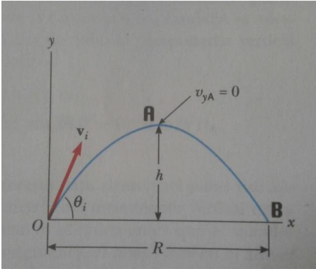
**Fig. 3** Un proyectil disparado desde el origen en  $t_t = 0$ , a una velocidad inicial  $v_i$ . La altura máxima de un proyectil es  $h$ , y el alcance horizontal es  $R$
