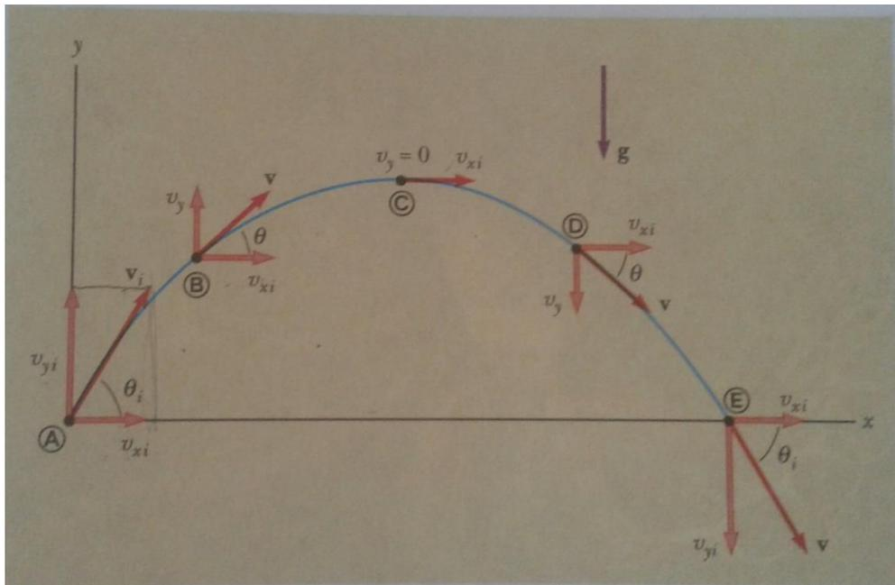
**Fig. 2** La trayectoria parabólica de un proyectil
