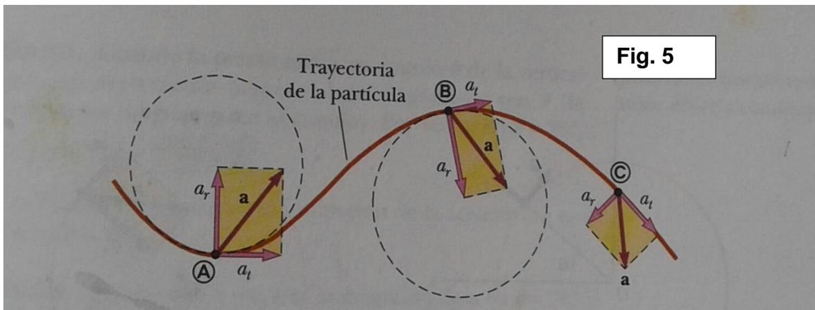
El vector velocidad siempre es tangente a la trayectoria, pero ahora la dirección del vector aceleración  $\mathbf{a}$  cambia de punto a punto. Este vector puede resolverse en dos vectores componentes: un vector componente radial,  $\mathbf{a}_r$ , y un vector componente tangencial,  $\mathbf{a}_t$ . Es decir,  $\mathbf{a}$  puede escribirse como la suma vectorial de estos vectores componente:
