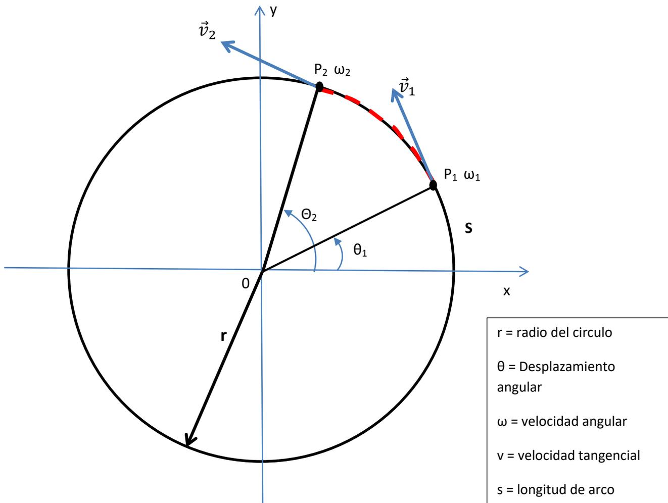
**Fig. 4** Una partícula sobre un objeto rígido en rotación se mueve de  $P_1$  a  $P_2$  a lo largo del arco de un círculo. En el intervalo de tiempo  $\Delta t = t_2 - t_1$ , el vector radio barre un ángulo  $\Delta\theta = \theta_2 - \theta_1$
