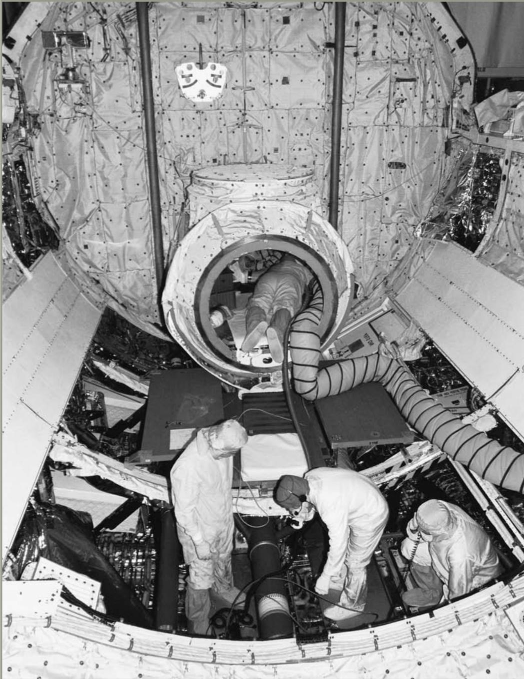
*Inspección de un túnel que conduce al compartimiento de carga.*
