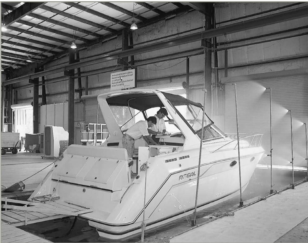
*En la etapa final, los botes se colocan en este tanque de pruebas y, donde una máquina de lluvia realiza las pruebas de hermeticidad.*
