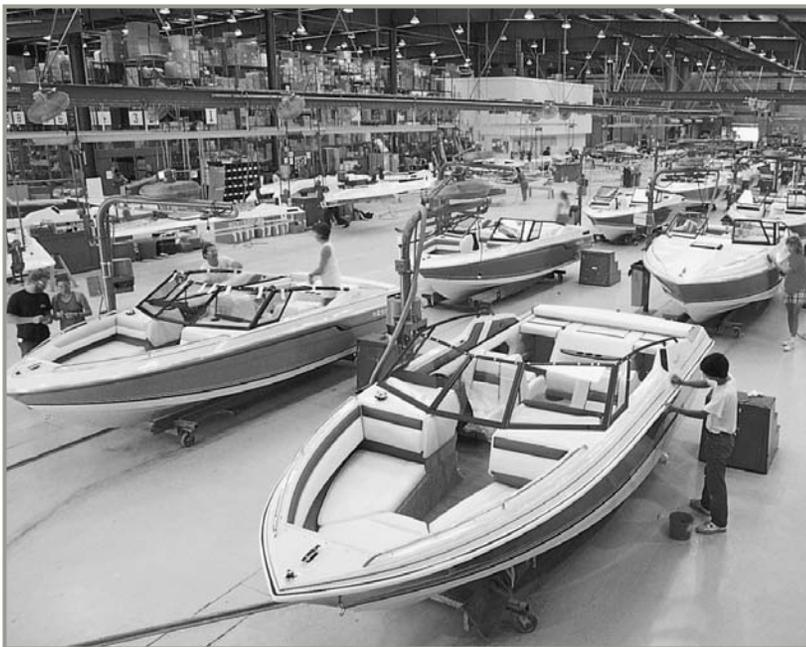
*Una vez que se tiene el casco a partir de un molde, recorre la línea de ensamble por un monorriel, donde un inventario JIT entrega motores, cables, pisos e interiores cuando se necesitan.*
