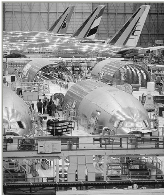
cuerpo del avión, incluyendo la mayor parte del fuselaje, partes de las alas y las puertas del tren de aterrizaje.
