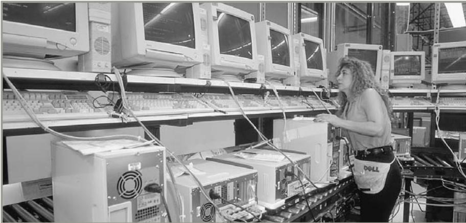
*Dell prepara juegos de componentes para cada cliente. Después las partes se envían a medida que se necesitan donde el ensamble del producto final está a cargo de personas altamente capacitadas, quienes arman la computadora completa.*
