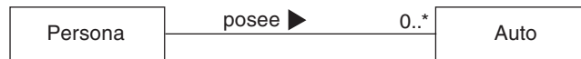
Figura 17.8. Una asociación navegable representa a una persona que posee (es propietaria) de varios carros, pero no implica que un auto pueda ser propiedad de varias personas.
