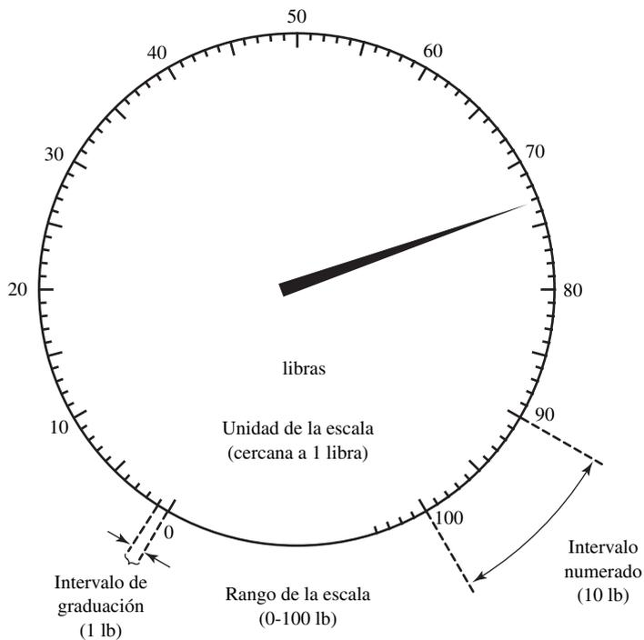
**Figura 7.14** Características básicas del diseño de un marcador.
