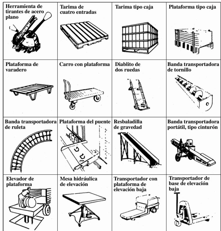
**Figura 3.13** Equipo de manejo típico que actualmente se utiliza en la industria.
