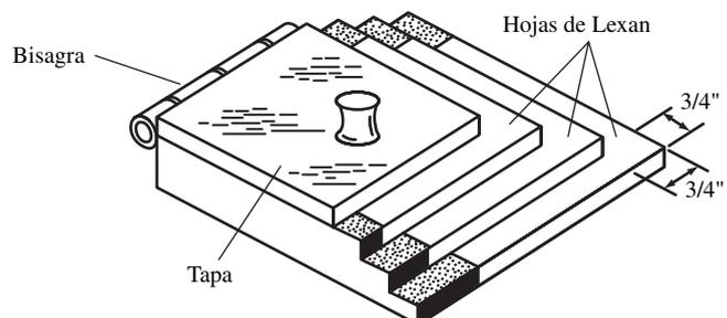
**Figura 5.17** Accesorio para remover papel protector de  $\frac{3}{4}$  de pulgada de ancho en la periferia de las hojas Lexan.
