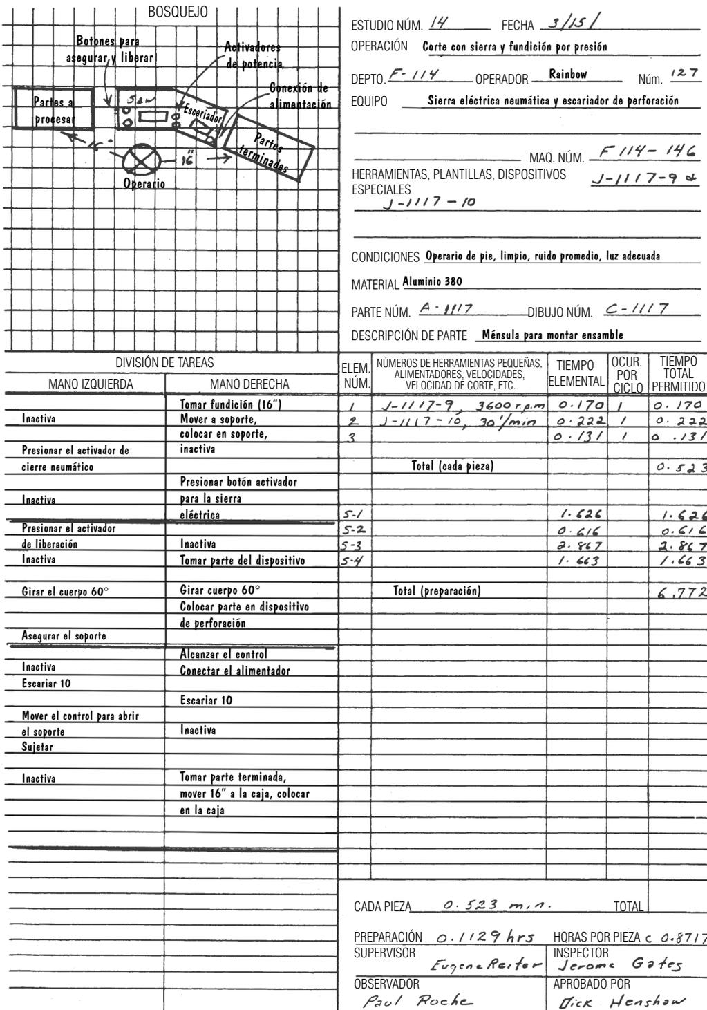
**Figura 10.10** Reverso de la forma para el estudio de tiempos mostrada en la figura 10.8. El estudio indica un tiempo por pieza de 0.523 min (0.8717 h/C) y un tiempo de preparación de 6.772 min (0.1129 h).
