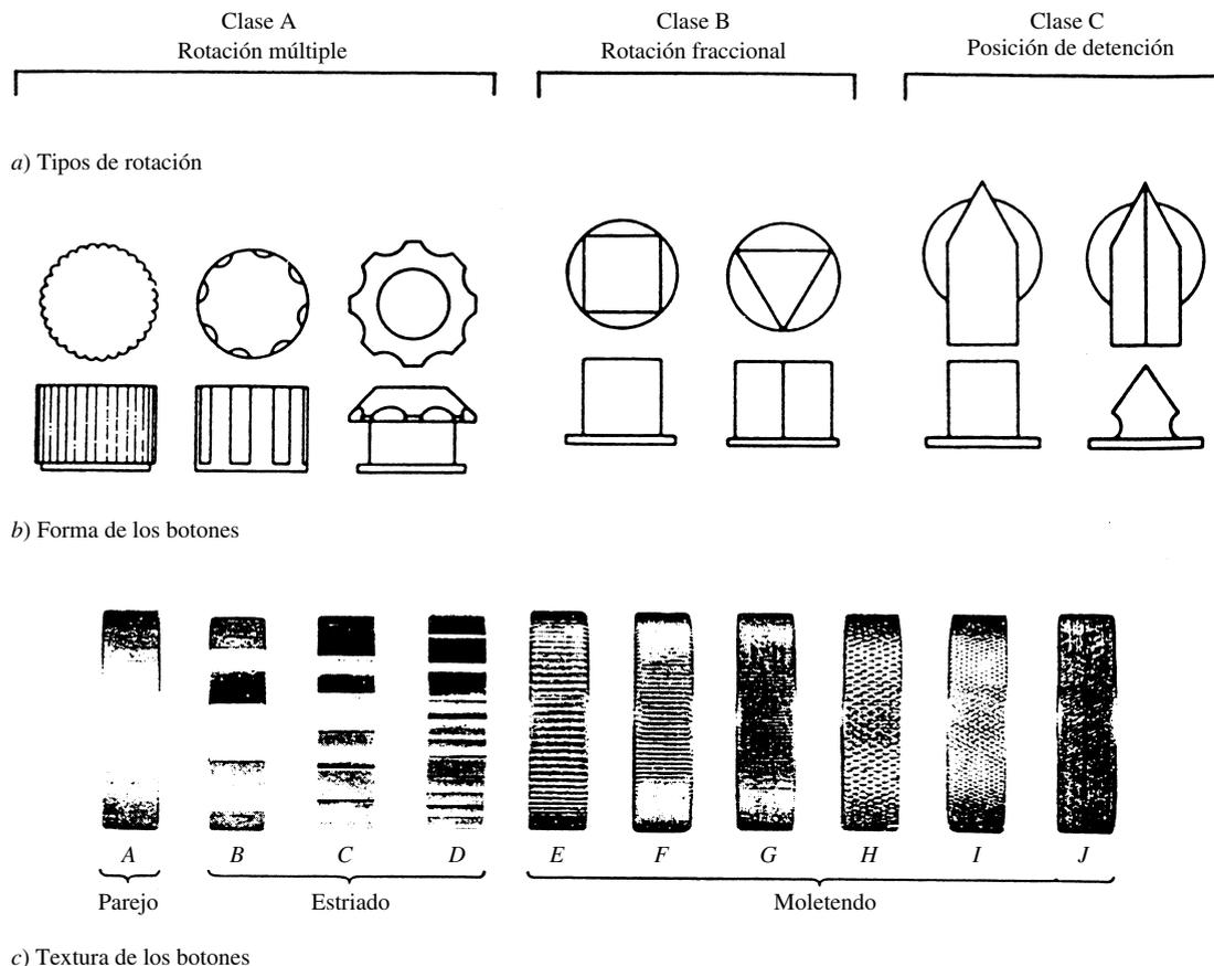
**Figura 5.18** Ejemplos de diseños de perillas para tres clases de uso que prácticamente nunca se confunden a través del tacto.
