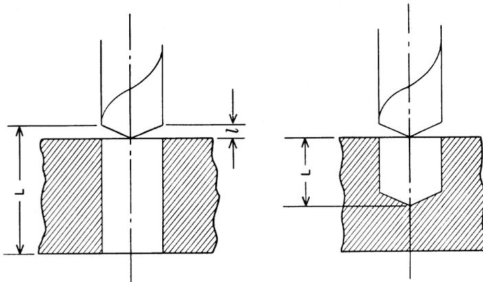
**Figura 12.4** Distancia de recorrido del taladro. La distancia  $L$  indica la distancia que recorre el taladro cuando la perforación atraviesa (ilustración de la izquierda) y cuando se perforan orificios ciegos (ilustración de la derecha) (la saliente del taladro se muestra mediante la distancia  $l$ ).
