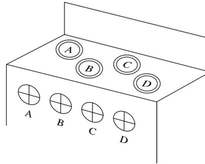
**Figura 7.12** Compatibilidad espacial de los controles y los quemadores ubicados en la cubierta de una estufa.
