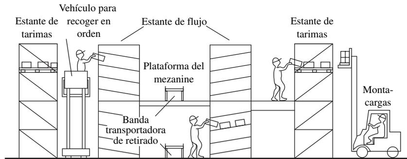
Figura 3.14 Diagrama de operaciones eficientes de almacenamiento.
