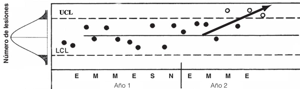
**Figura 8.11** Indicación de peligro mediante un diagrama de control.
