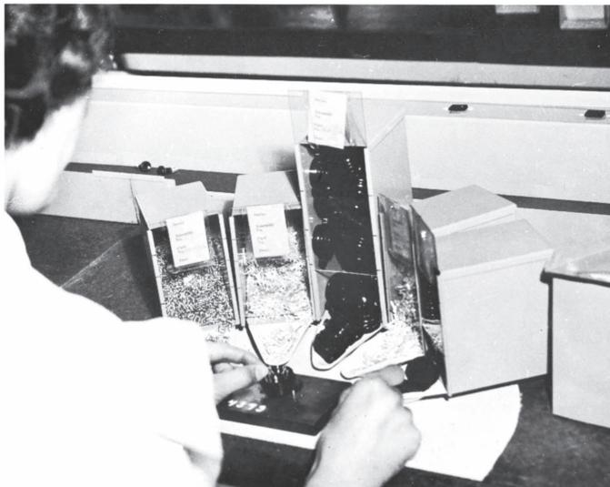
**Figura 5.15** Estación de trabajo que utiliza contenedores por gravedad y una banda transportadora que reduce los tiempos de alcance y de movimientos. La banda transportadora en la parte posterior de la foto transporta otras partes además de las necesarias para esta estación de trabajo en particular. El operador alimenta dicha banda desde abajo de la plataforma con sólo dejar caer las partes ensambladas en la banda de alimentación (Fuente: Alden Systems Co.)
