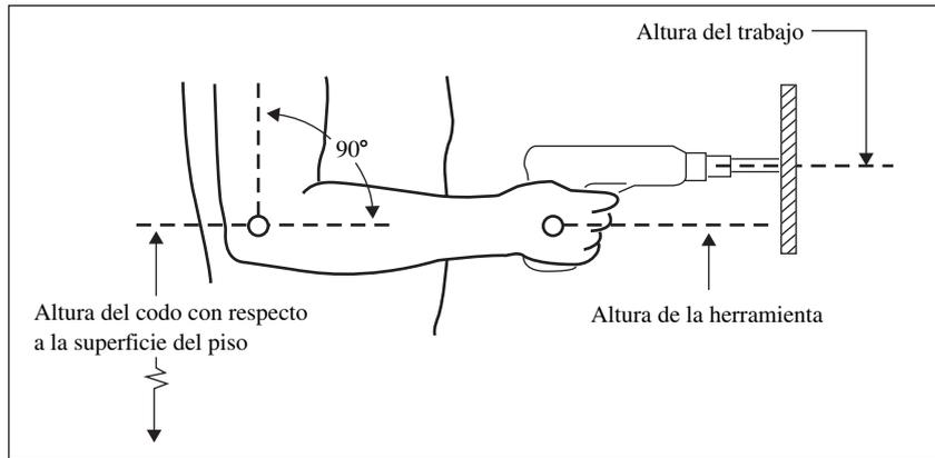
**Figura 5.4** Ayuda gráfica para determinar la altura correcta de la superficie de trabajo.
