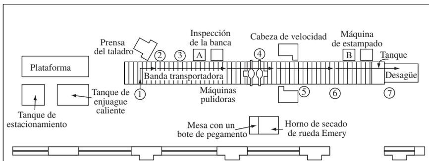
**Figura 2.13** Diagrama de flujo de la distribución revisada de un grupo de operaciones del rifle Garand M1.
