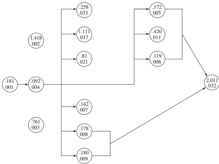
**Figura 2.20** Diagrama de precedencia terminado en forma parcial. Observe que los elementos de trabajo 002 y 003 pueden realizarse en cualquier secuencia respecto a cualquier otro elemento de trabajo, y que el 032 no puede comenzar hasta que se hayan terminado los elementos de trabajo 005, 006, 008 y 009. Observe también que inmediatamente después de que el elemento de trabajo 004 haya sido terminado, podemos arrancar con los elementos de trabajo 033, 017, 021, 005, 011, 006, 007, 008 o 009.
