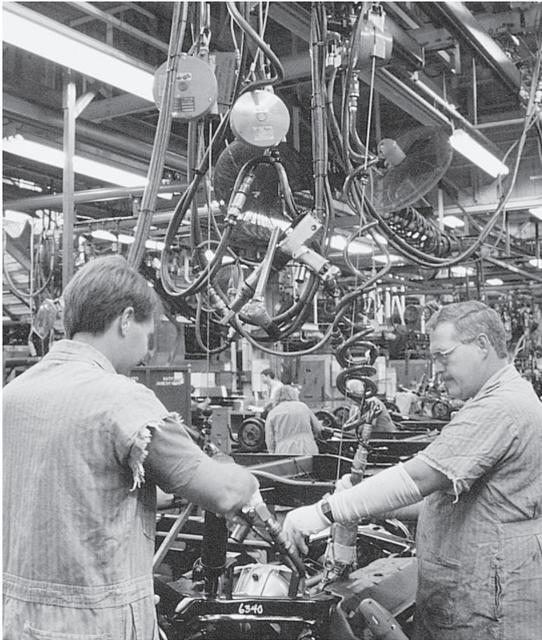
**Figura 5.14** Los sujetadores de herramienta proporcionan una ubicación fija de las herramientas.
