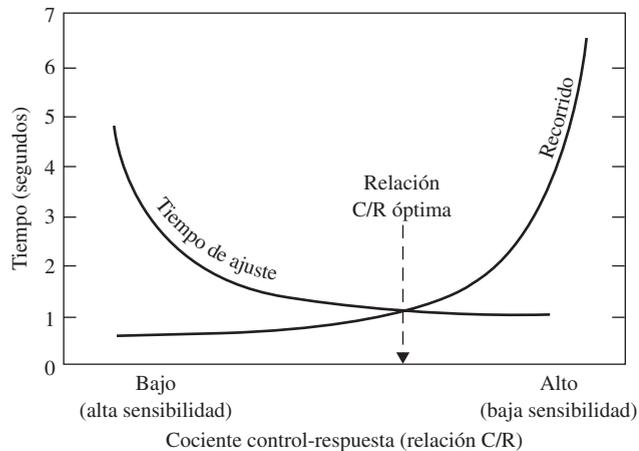
**Figura 5.20** Relación entre el cociente C/R y la duración del movimiento (tiempo de recorrido y tiempo de ajuste). Los cocientes C/R específicos no tienen ningún significado fuera de su contexto original, por lo que aquí se omiten. Sin embargo, dichos datos muestran típicamente la naturaleza de las relaciones, en especial en los controles por medio de botones. (Fuente: Jenkins y Connor, 1949.)
