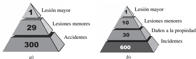
**Figura 8.4** a) Triángulo de la tasa de accidentes de Heinrich; b) Triángulo de la tasa de accidentes de Bird y Germain (1985). (Adaptado de: Heinrich, Petersen y Roos, 1980.)
