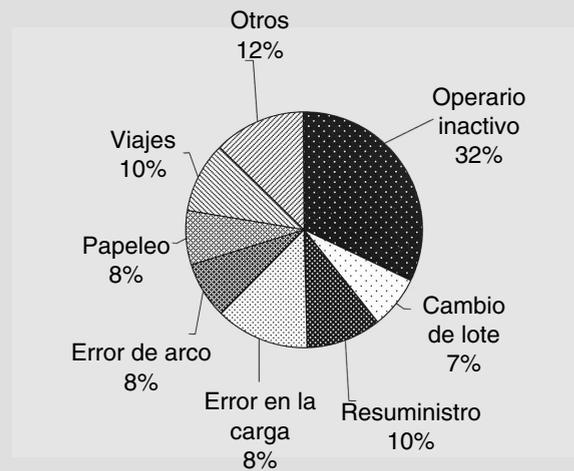
**Figura 14.11** Utilización del operario en máquinas de perforado.
