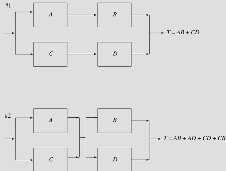
**Figura 8.13** Dos prototipos de un amplificador de dos etapas.
