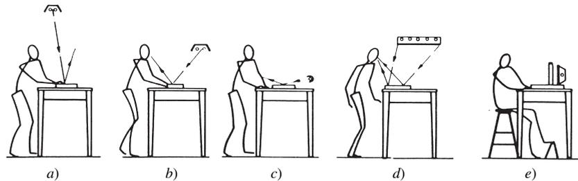
coloca la superficie del trabajo en posición perpendicular a la fuente de luz y se incrementa la iluminación panorámica del fondo de tal manera que disminuya el contraste.
