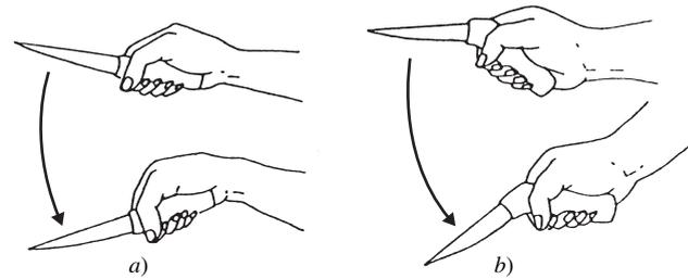
**Figura 5.28** a) Cuchillo alineado convencional. b) Cuchillo de sujeción tipo pistola. (De: Putz-Anderson, 1988.)
