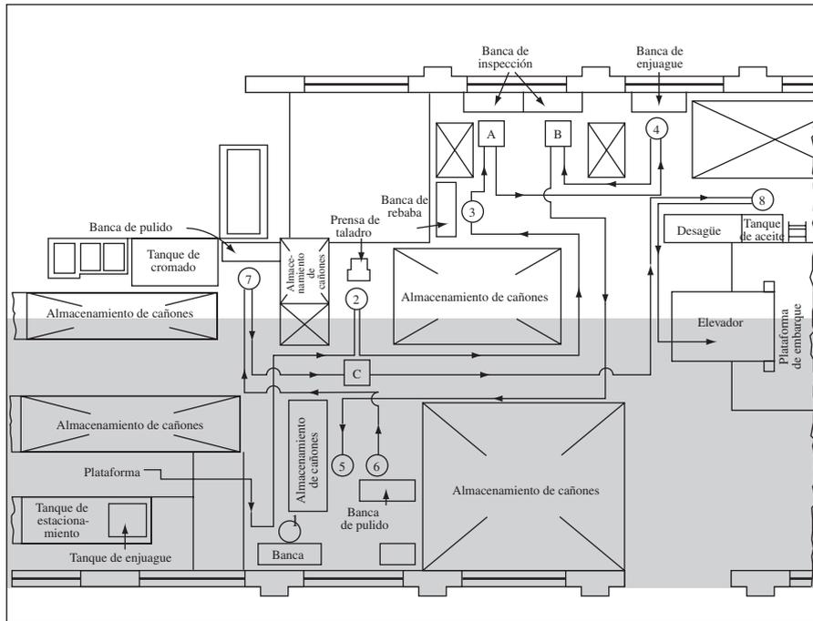
**Figura 2.12** Diagrama de flujo de la distribución antigua de un grupo de operaciones del rifle Garand. (La sección sombreada de la planta representa el espacio total necesario para la distribución revisada [figura 2.13]. Ésta representa 40% de ahorro de espacio.)
