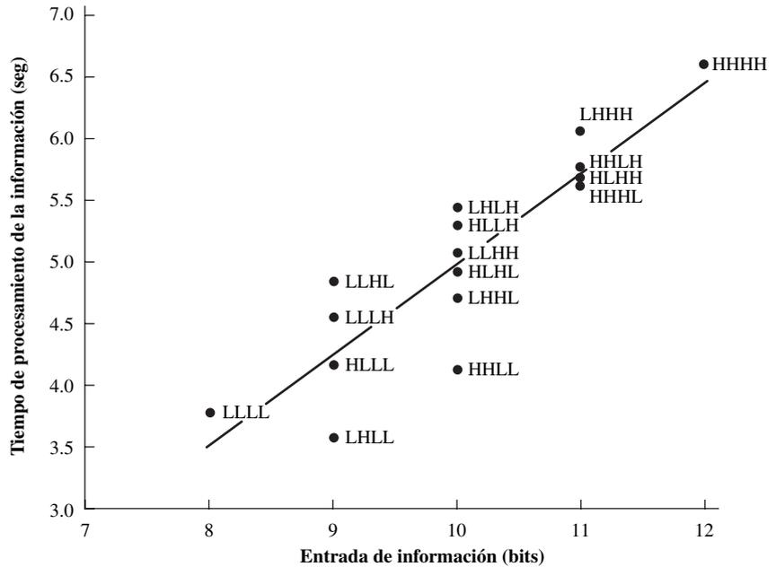
**Figura 7.6** Ley de Hick-Hyman aplicada a una tarea de cableado. (Reimpreso de *Applied Ergonomics*, vol. 19, “Bishu y Drury, Information Processing in Assembly Task—A Case Study”, pp. 90-98, 1988, con el permiso de Elsevier Science.)
