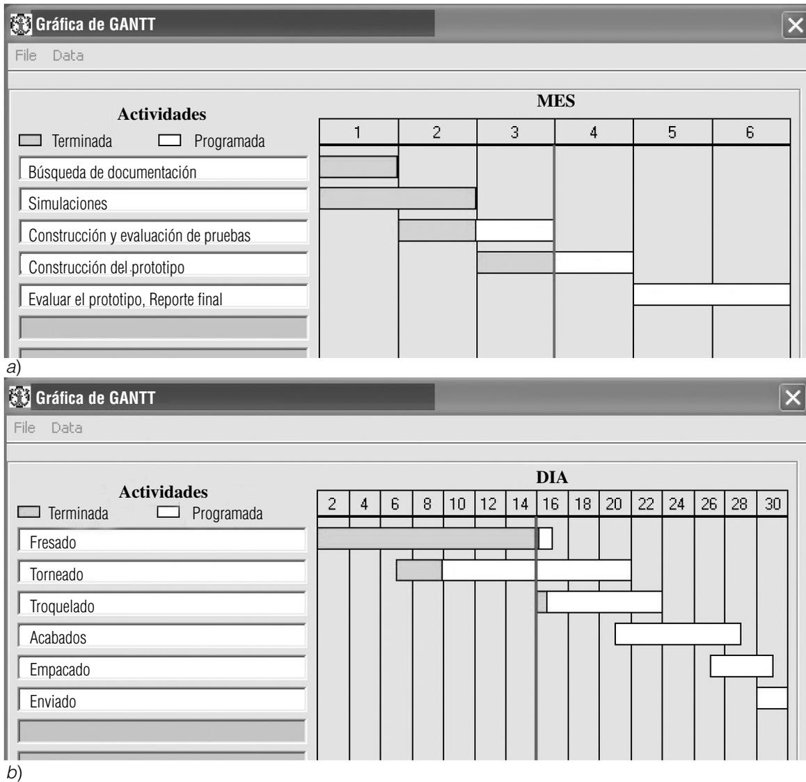
**Figura 2.3** Ejemplo de a) una gráfica de Gantt basada en un proyecto y b) una gráfica de Gantt basada en procesos o maquinaria.
