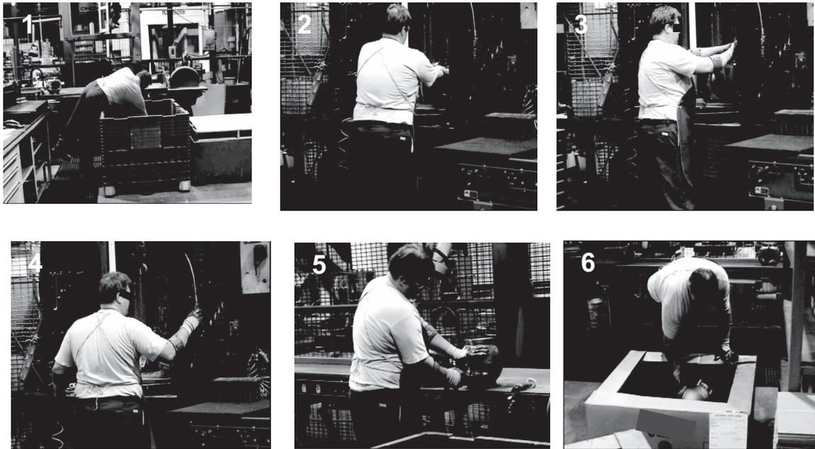
**Figura 8.6** Etapas en el maquinado de un acoplamiento.
