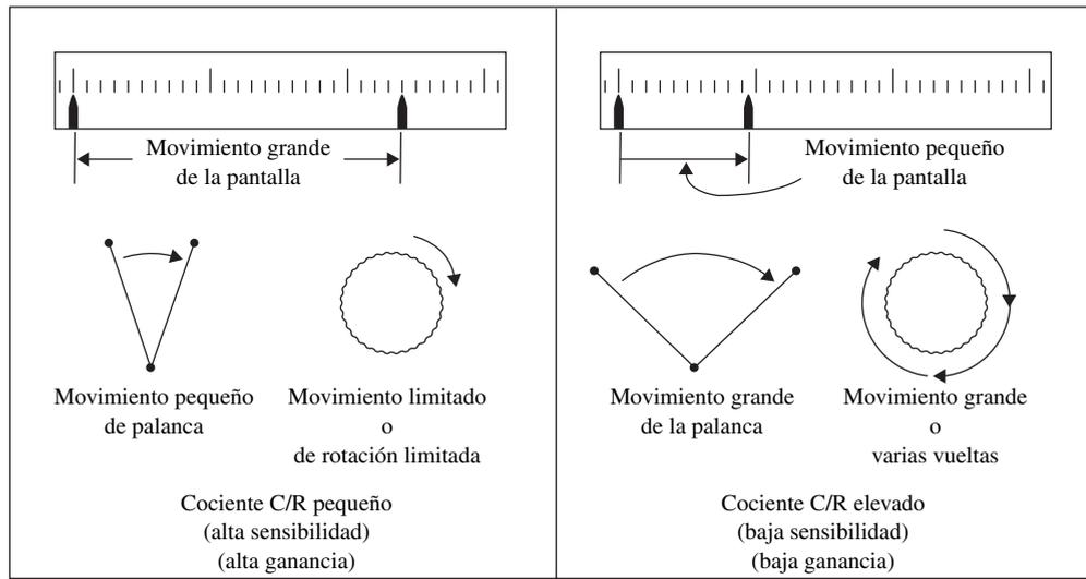
**Figura 5.19** Ilustraciones generales de cocientes control-respuesta (relaciones C/R) altos y bajos para controles de palanca y rotatorios. El cociente C/R es una función del enlace entre el control y la pantalla.
