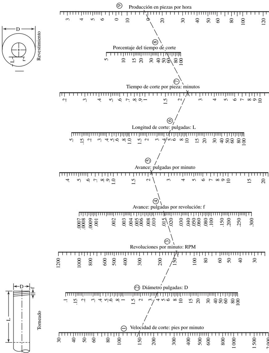
**Figura 12.1** Nomograma para determinar el tiempo de revestimiento y torneado. (Crobalt, Inc.)
