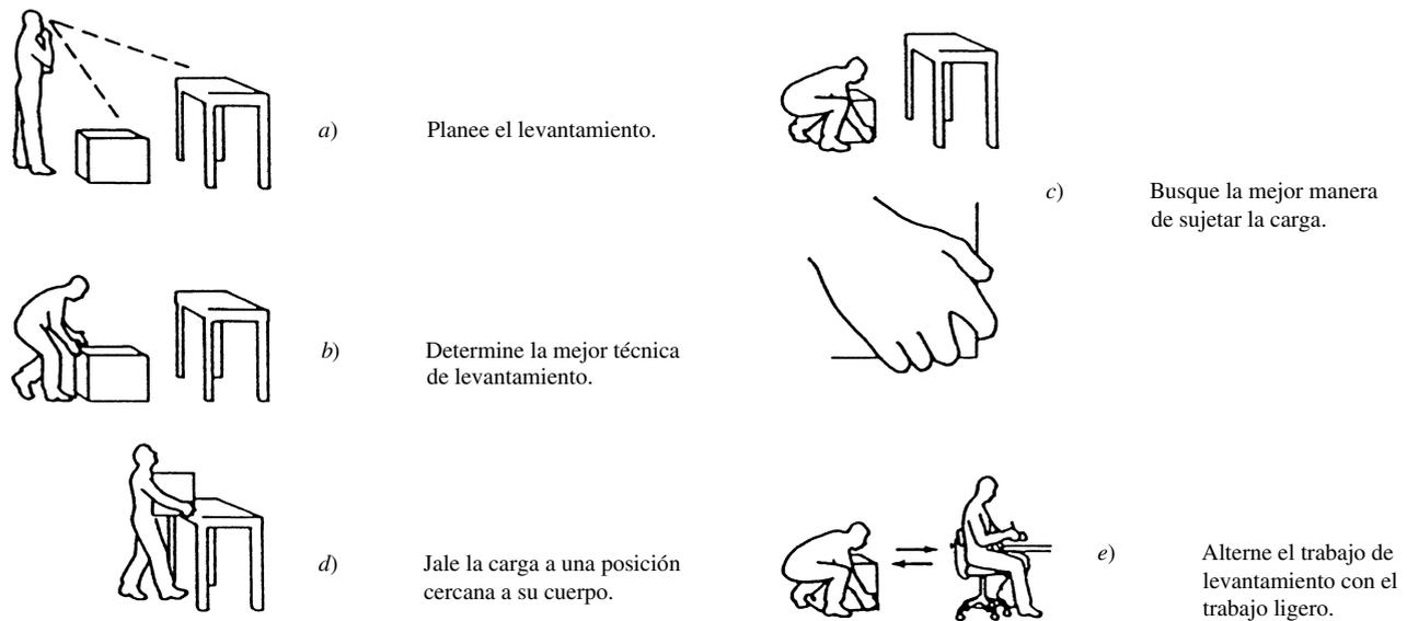
**Figura 4.30** Procedimiento para un levantamiento seguro.
