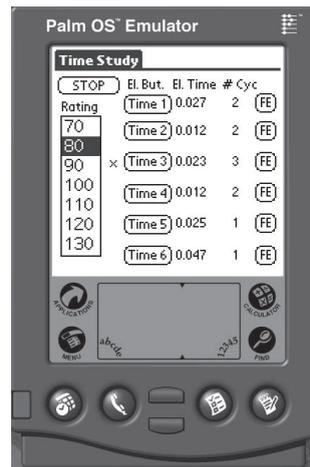
**Figura 10.5** Programa QuickTS para el estudio de tiempos en una Palm PDA.
