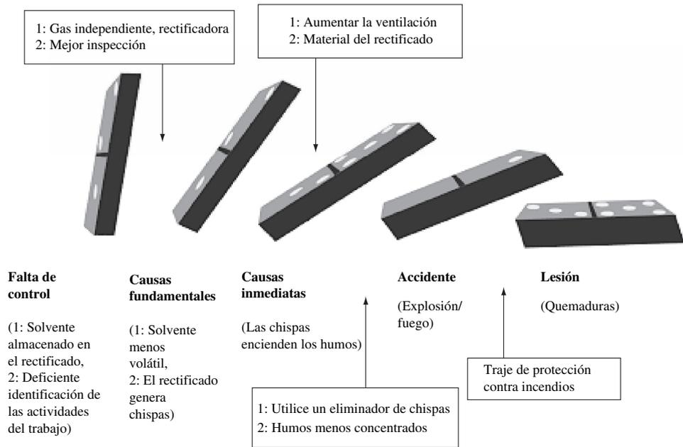
**Figura 8.3** Secuencia dominó de la chispa de un rectificado que provoca un incendio.
